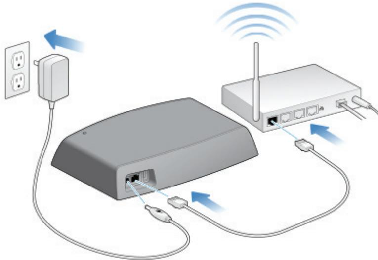
Durante a inicialização do dispositivo Seagate Central, o LED na parte superior permanece amarelo. Quando o LED muda para a cor verde, o dispositivo está conectado à Internet e pronto para ser usado.
