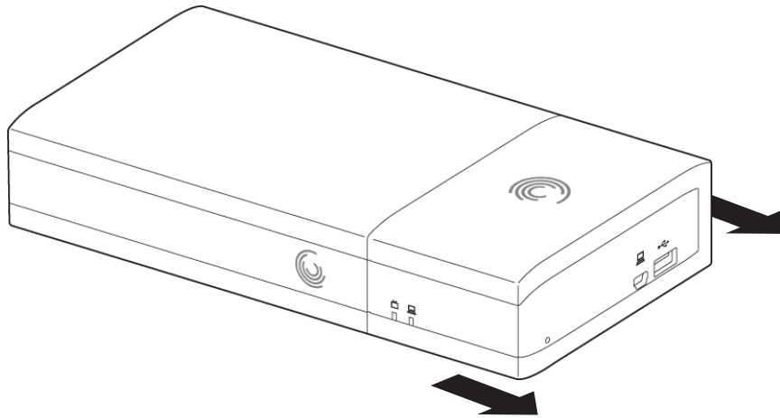
شكل ٧: فصل المرسى GoFlex Cinema عن المحرك GoFlex Cinema
