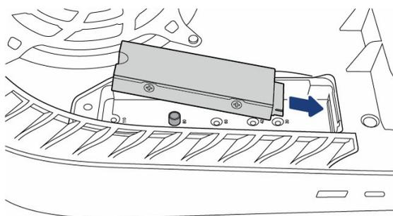
**!** **Importante:** Asegúrese de que la SSD de Game Drive PS5 NVMe está insertada hasta el fondo en el conector de expansión antes de ir al siguiente paso. Si la SSD de Game Drive PS5 NVMe se inserta incorrectamente puede dañar el terminal y la consola.
